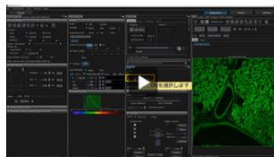
7. Z位置ごとにレーザー・HVの設定を変えてスキャン(BrightZ)
