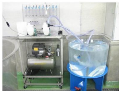
図4 鹿島灘はまぐりの浮遊幼生用バブル発生装置
