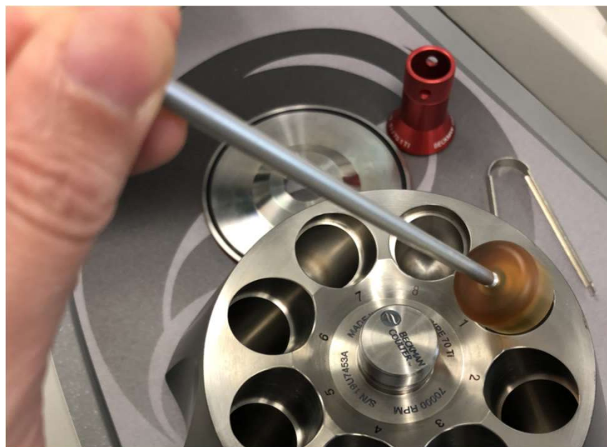
..... スペーサーの引き抜き
