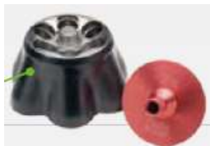
Type 45 Ti 最高遠心力235,000g 最大処理容量 564 mL
