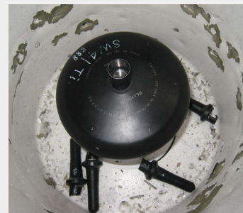
▲共同研で実際に起こった事故。 遠心中にバケットが外れ、バランスが崩れて超遠心機が破損した。
