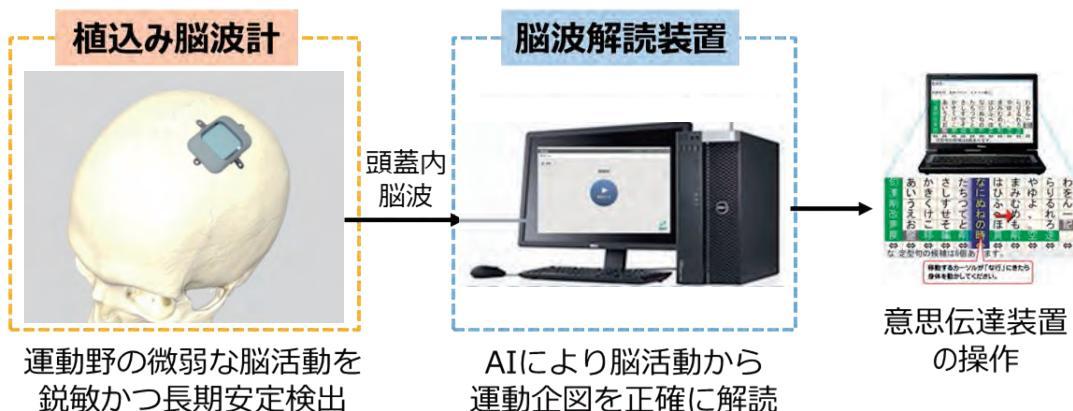
ブレイン・マシン・インターフェース (BMI) とは脳信号から運動や意思疎通の内容を読み取り、ロボットアームや意思伝達装置をコントロールする技術で、身体障害者の障害された機能を代替する技術として期待されています。本シーズでは、私共が研究開発してきた、脳の表面において電極から計測する正確な脳波（頭蓋内脳波）を用いたワイヤレス植込み型BMI装置の治験を行い、企業へ導出することを目指します。
