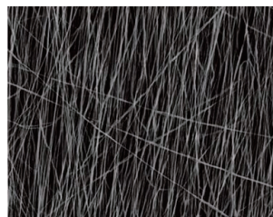
\epsilon -カプロラクトン(PCL)より作成した ナノファイバー・スキャフォールド 電子顕微鏡像
