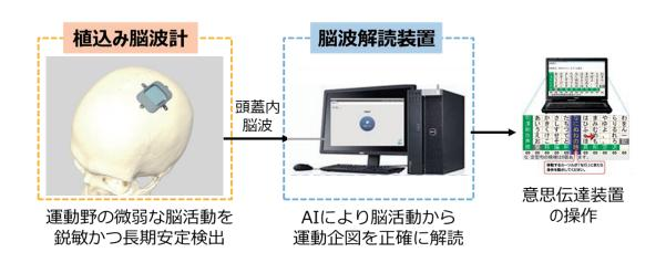
ブレイン・マシン・インターフェース (BMI) とは脳信号から運動や意思疎通の内容を読み取り、ロボットアームや意思伝達装置をコントロールする技術で、身体障害者の障害された機能を代替する技術として期待されています。本シーズでは、私共が研究開発してきた、脳の表面においた電極から計測する正確な脳波(頭蓋内脳波)を用いたワイヤレス植込み型BMI装置の治験を行い、企業へ導出することを目指します。
